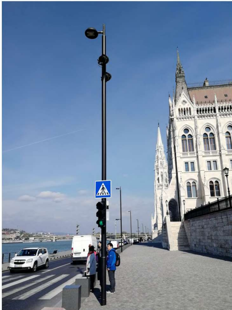
ХОРОШО. Один столб используется для крепления светофора, дорожных знаков и осветительного фонаря
