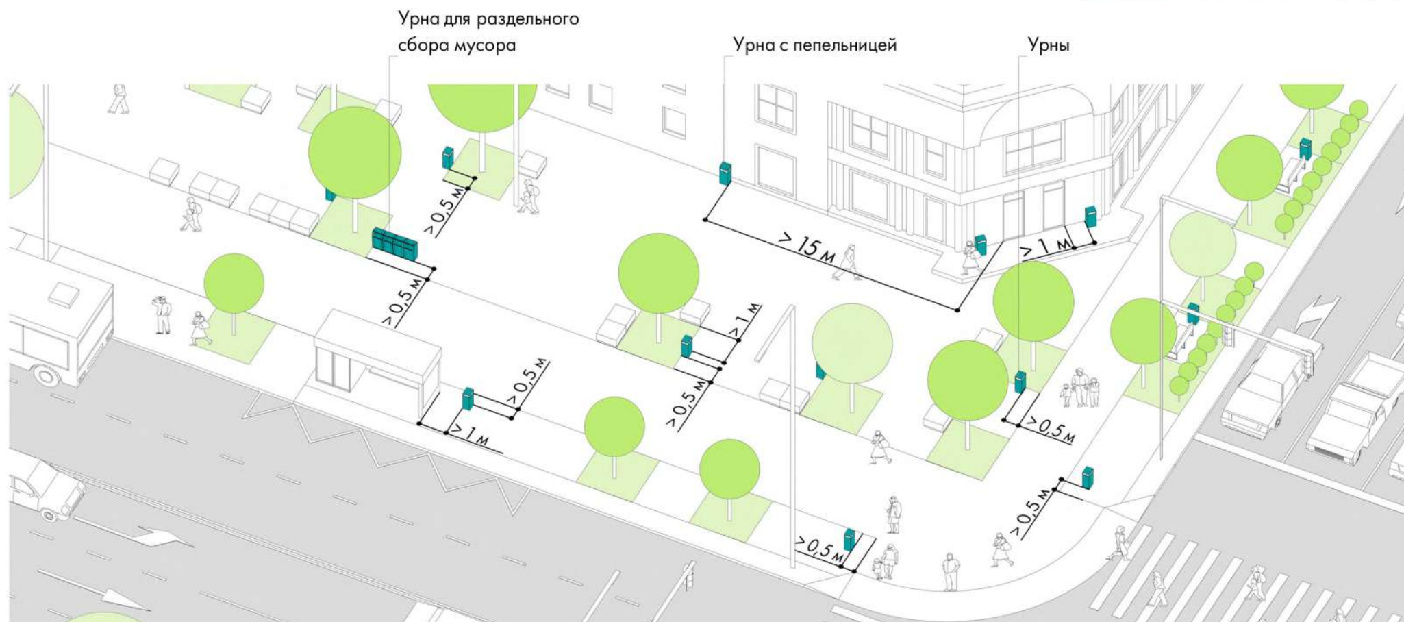
Принципиальная схема размещения урн на УДС и зонах отдыха.
