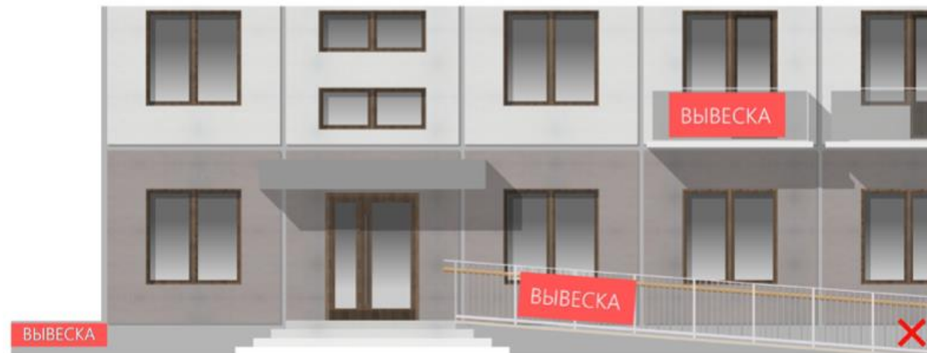
20. Запрещено размещать вывески на балконах, лоджиях, ограждениях лестниц, стенах приемков.
