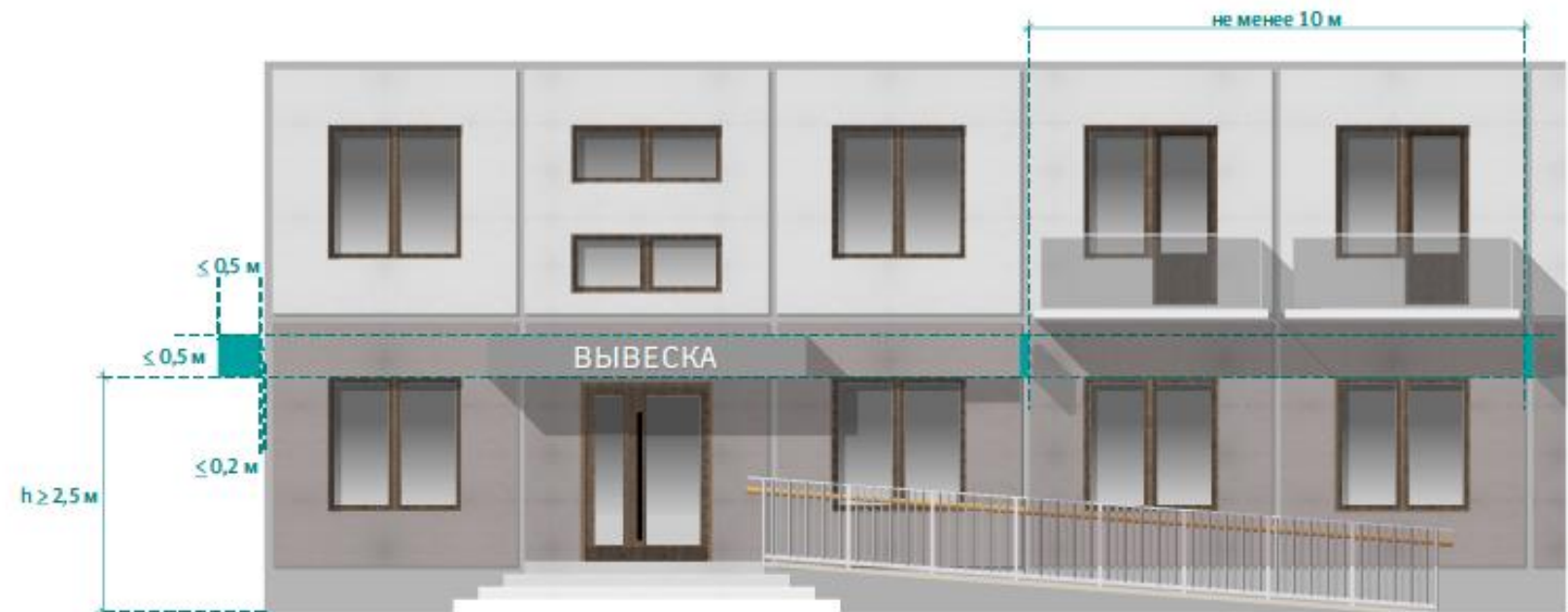
ХОРОШО. Панели-кронштейны расположены на одной высоте с настенными вывесками на расстоянии не менее 10 метров друг от друга
