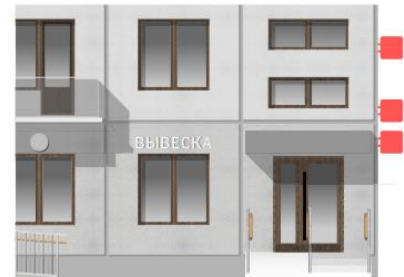
ПЛОХО. Панели-кронштейны расположены в два уровня и более
