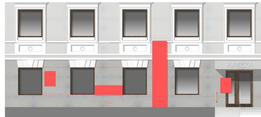
ПЛОХО. Информационный стенд расположен хаотично на фасаде и его габариты превышают нормативные
