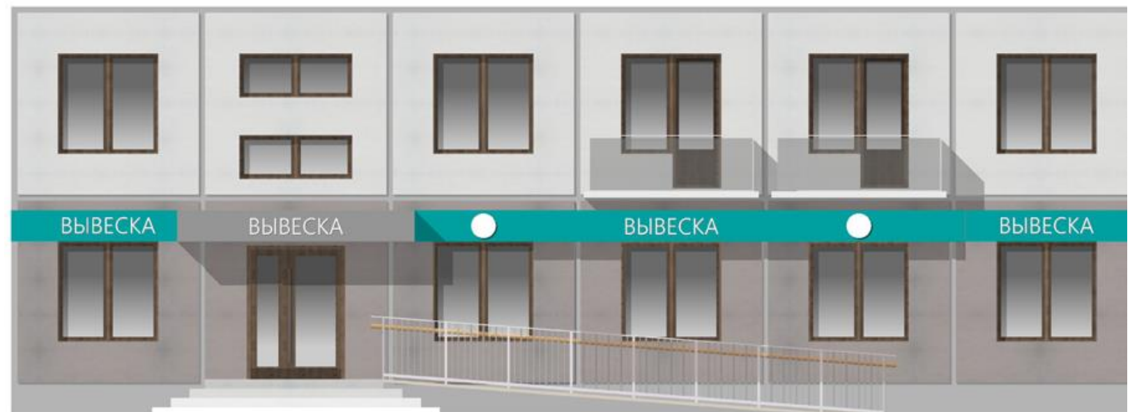
ХОРОШО. Вывески имеют единый вид на одном фасаде, выполнены с подложкой и в общем масштабе
