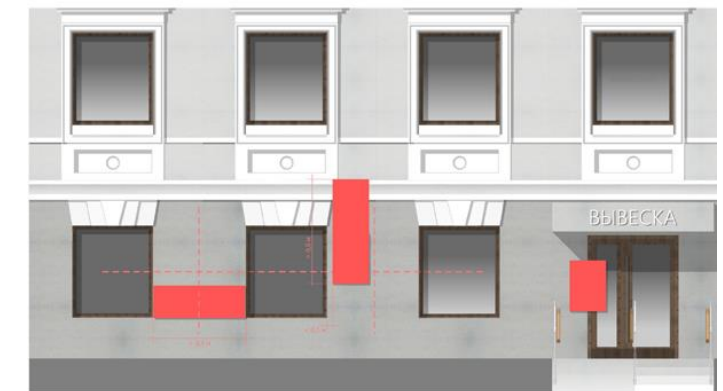
ПЛОХО. Информационный стенд расположен хаотично и перекрывает декоративные детали фасада
