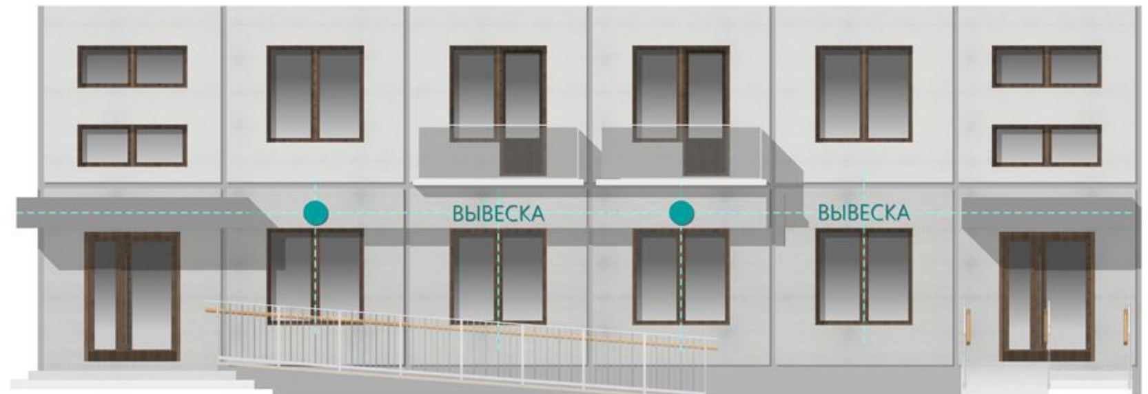
ХОРОШО. Вывески привязаны к центральным осям архитектурных элементов фасада и соосны друг другу
