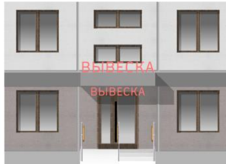
ПЛОХО. Вывеска расположена под или над козырьком
