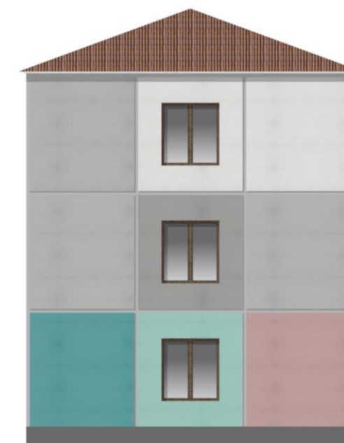
ПЛОХО. Торцы имеют фрагментарную отделку
