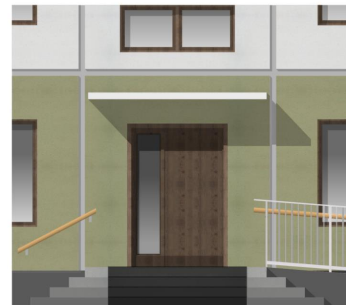
ХОРОШО. На входной лестнице предусмотрен противоскользящий коврик
