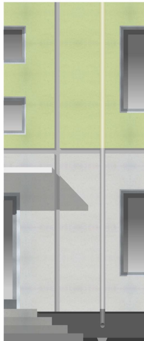
ХОРОШО. Водосточная труба имеет отвод в водоприемный лоток
