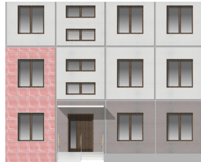
ПЛОХО. Фасад имеет фрагментарную отделку разными материалами
