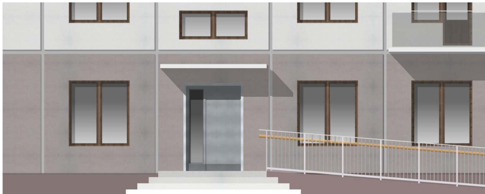
ХОРОШО. Цоколь выполнен из одного материала, сочетается по цвету с фасадом здания
