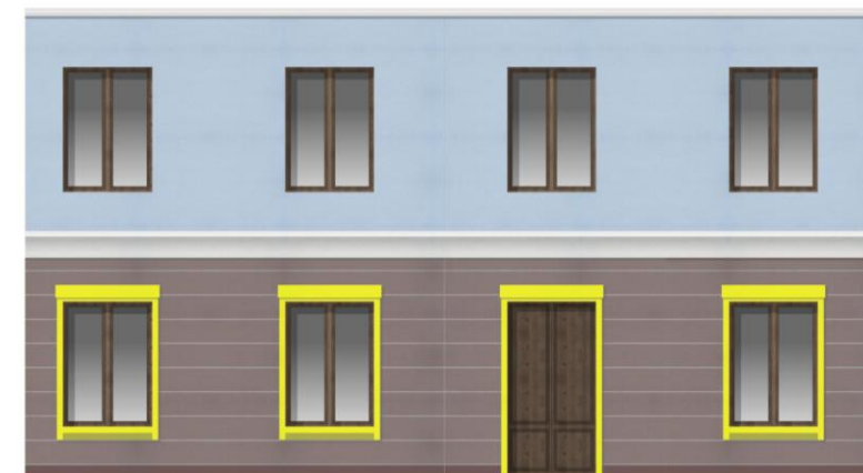
ПЛОХО. Окраска декоративных деталей с нарушением ПЦР
