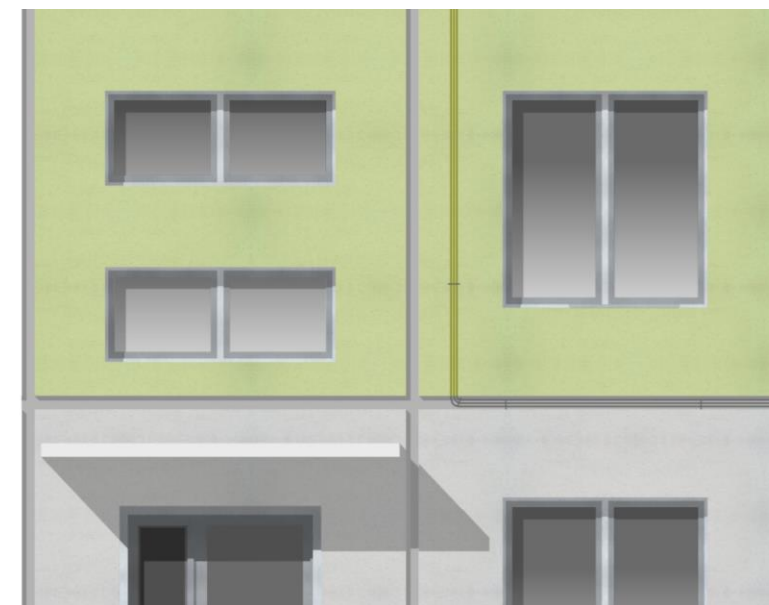
ХОРОШО. Инженерные провода упорядочены и выкрашены в цвет фасада
