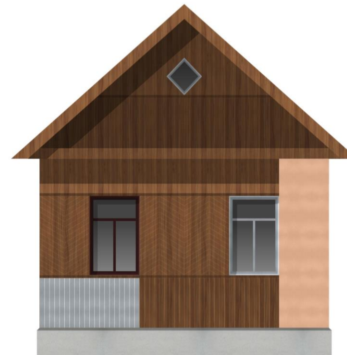
ПЛОХО. Деревянное здание потеряло исторический вид из-за фрагментарной отделки чужеродным материалом
