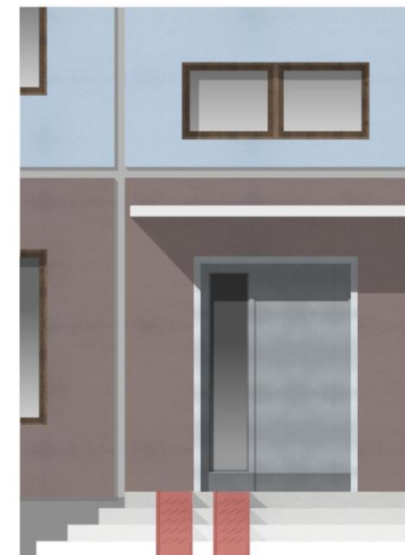
ПЛОХО. Применение аппарелей вместо пандусов не допускается
