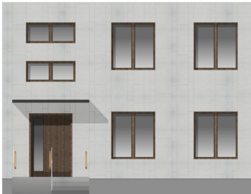
ХОРОШО. Фасад выполнен из одного материала
