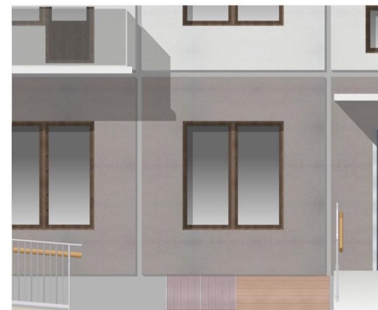
ПЛОХО. Цоколь не имеет единого решения, выполнен из разных материалов, не сочетается с отделкой и цветом фасада
