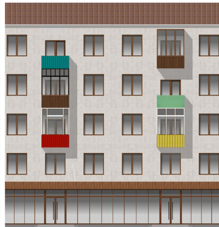
ПЛОХО. Балконы имеют разную отделку, они окрашены в произвольные цвета и неодинаково застеклены, что разрушает архитектурный образ здания
