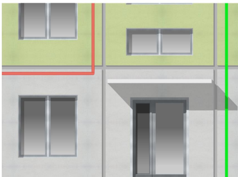
ПЛОХО. Инженерные провода проложены в коробах, контрастирующих с цветом фасада
