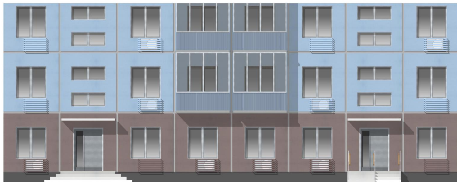
ХОРОШО. Кондиционеры размещены упорядоченно и закрыты декоративными коробами
