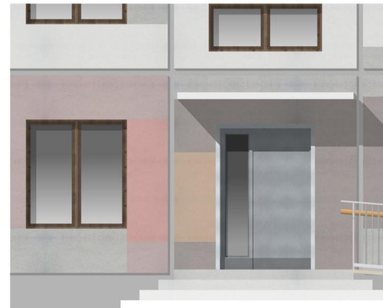
ПЛОХО. Цветовое решение фасада неоднородно, покраска стен выполнена хаотично с использованием разных оттенков одного цвета
