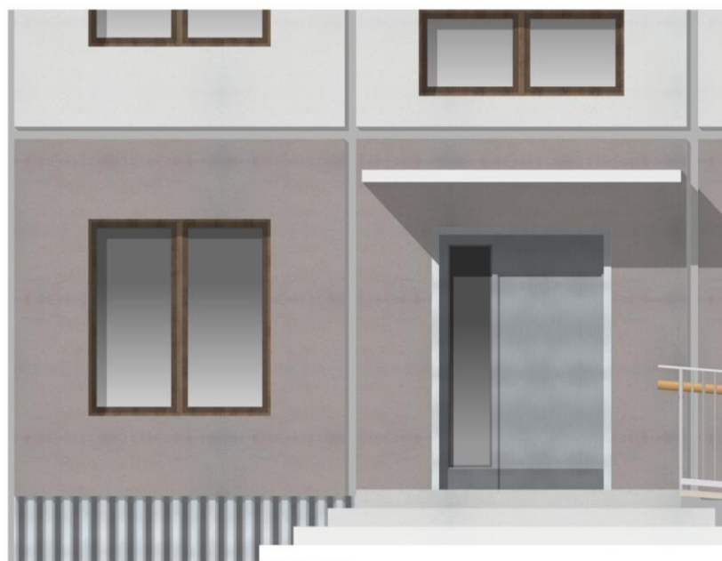
ПЛОХО. Цоколь выполнен из профилированного листа, материал чужероден архитектуре здания
