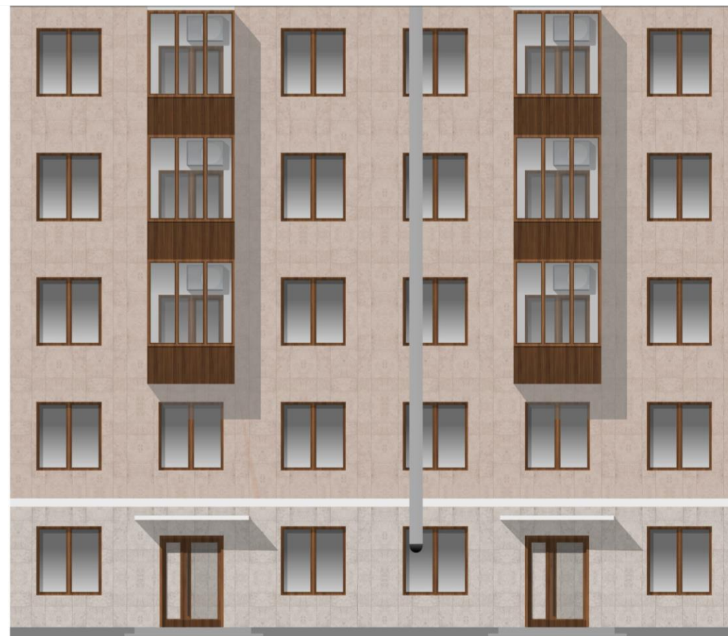
ПЛОХО. Вентиляционная труба перекрывает окна и выделяется на фоне фасада
