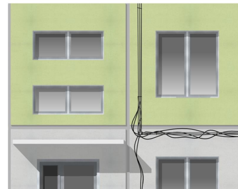
ПЛОХО. Инженерные провода расположены неупорядоченно
