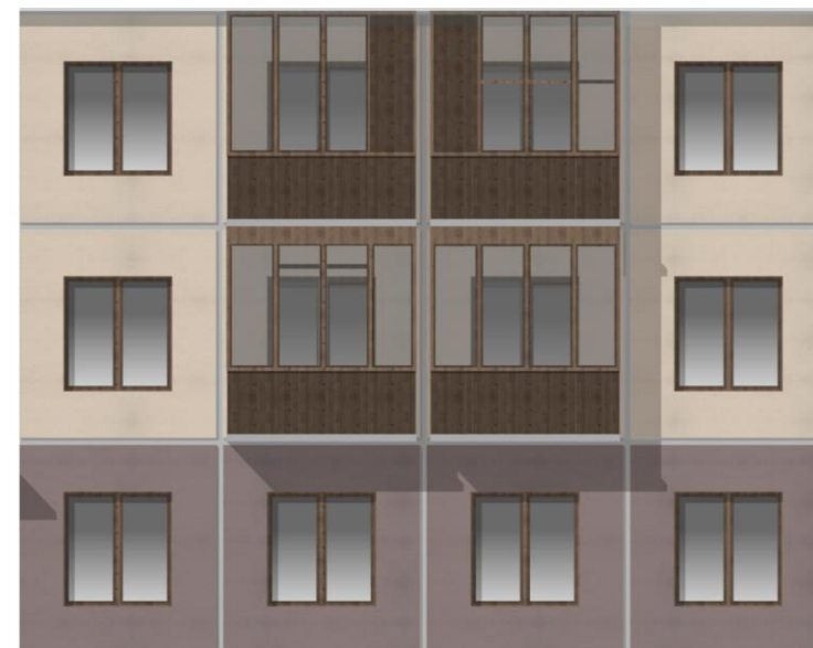
ДОПУСТИМО. Отделка балконов выполнена в едином стиле и материале, но остекление имеет разное членение и заполнение
