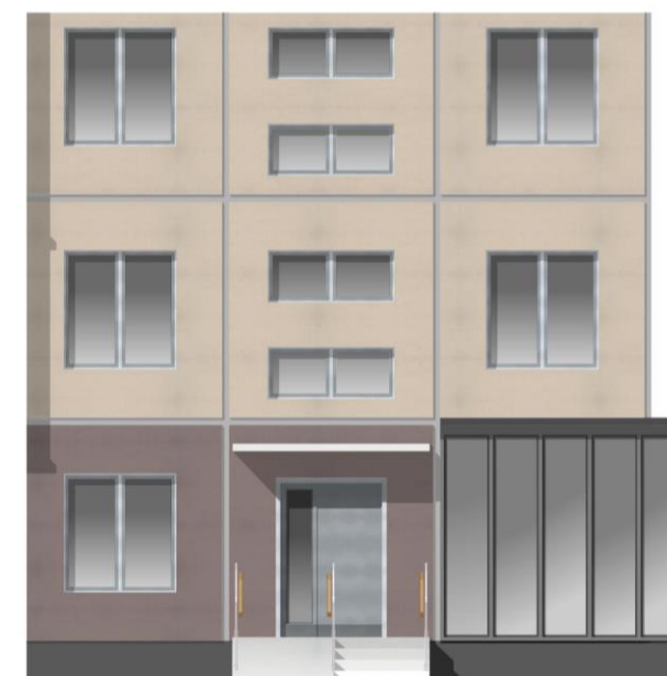
ДОПУСТИМО. Светопрозрачная пристройка оказывает меньшее визуальное воздействие на архитектуру
