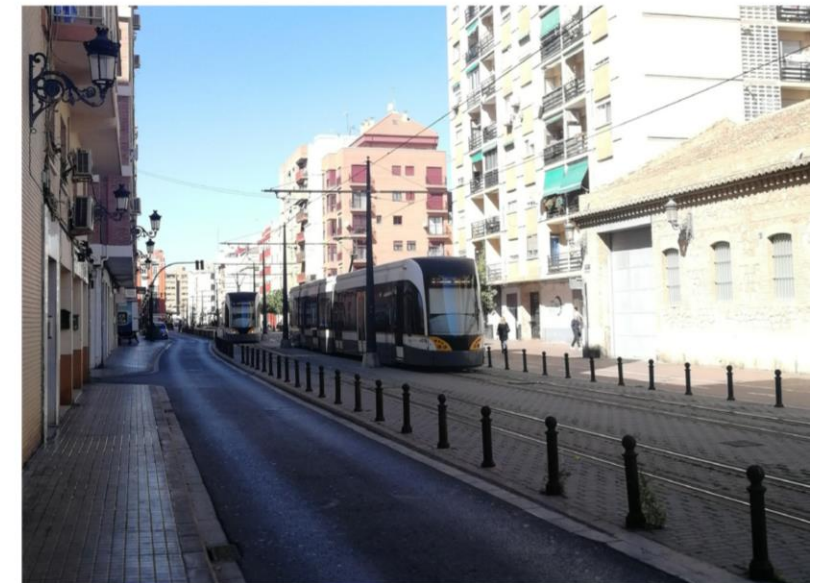
ХОРОШО. Металлические столбики эффективно разделяют транспортные потоки и не создают физических границ
