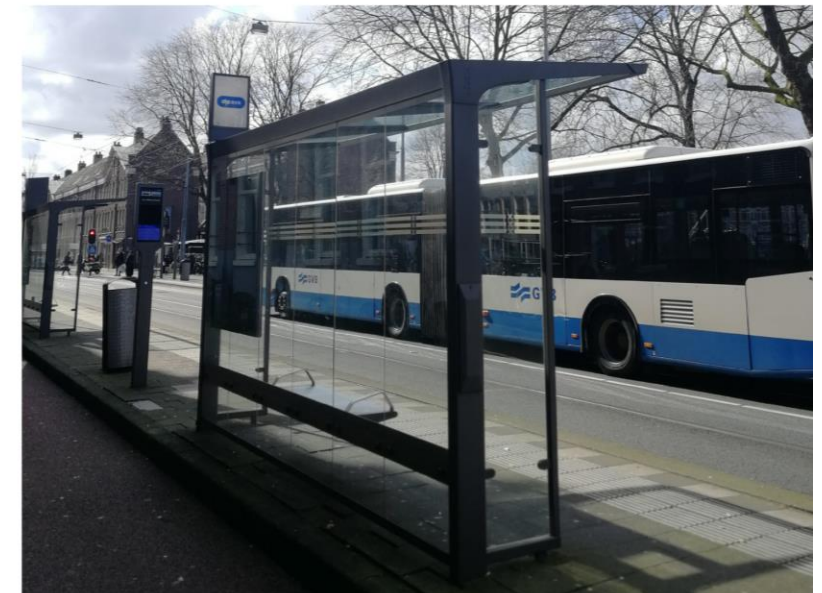
ХОРОШО. Остановка расположена в технической зоне и занимает минимум места, не преграждает пешеходный путь
