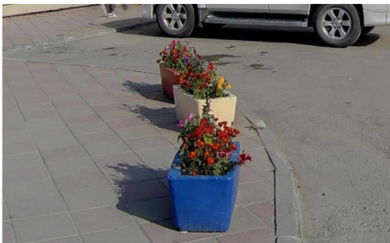
ПЛОХО. Кадки слишком малого размера: не видны для водителей, создается опасность наезда. Покрашены в яркую гамму, отвлекают от растений
