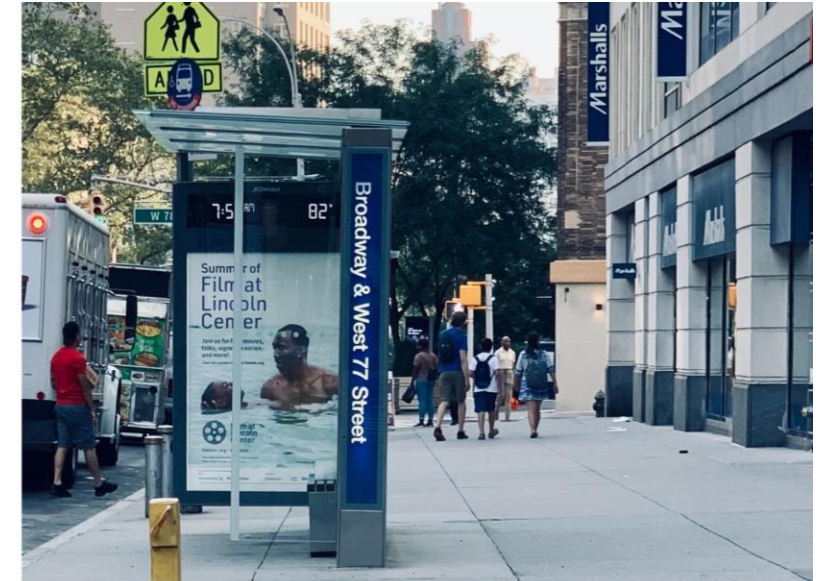
ПЛОХО. Между остановочным павильоном и проезжей частью не соблюдается нормативное минимальное расстояние 2 м
